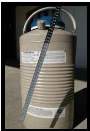
Apposita asta graduata per rilevare il livello di azoto
