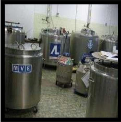
criobiologici non vi è presenza di liquidi, ma le particelle di aria presenti nell'intercapedine tra i due involucri di cui è costituito il contenitore sono in grado di trasmettere il calore per convezione.
