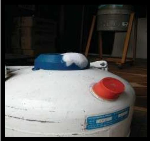
Brinatura dovuta alla rottura del collo del contenitore e perdita della coibentazione
